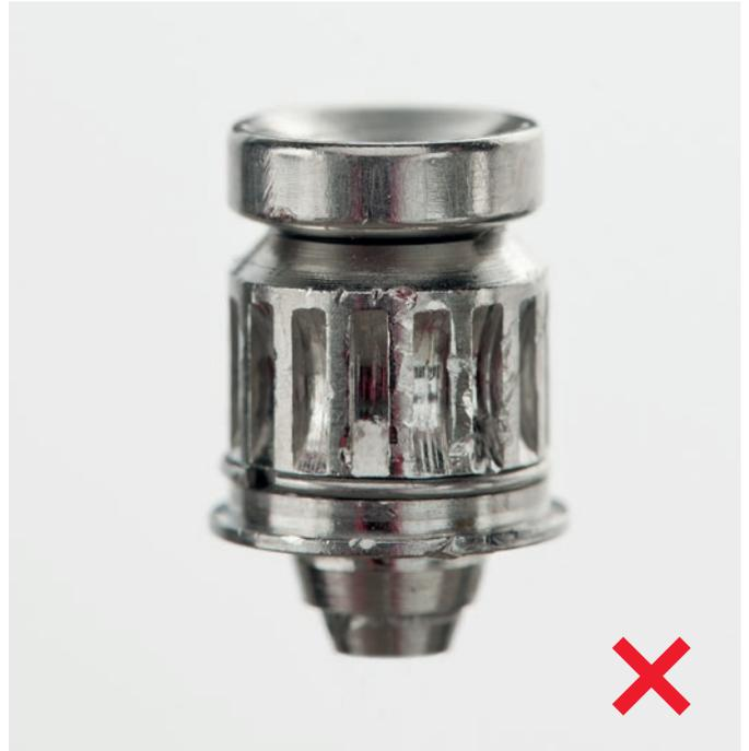
Estructura del adaptador desgastada
