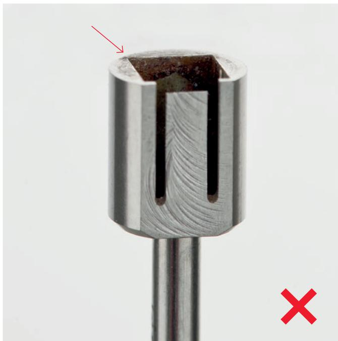
El instrumental con superficies oxidadas debe desecharse. Las imágenes son solo ejemplos y no muestran límites de aceptación. Los instrumentos solo ligeramente corroídos ya pueden no ser biocompatibles.
